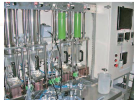
写真2：世界最高速の自動飛跡読取装置HTS。いずれは人工知能を搭載したい。
