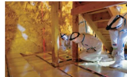
写真4：屈折ピラミッドでの原子核乾板設置の様子。分野の垣根を超えた研究も積極的に推進する。
