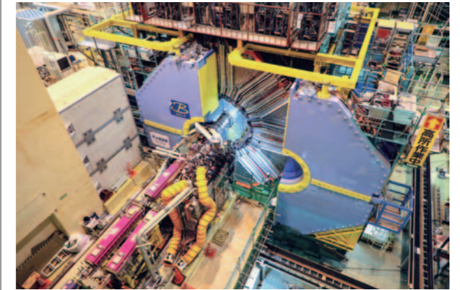
ビームラインへの実装が完了したスーパーBファクトリー実験の検出器。本実験開始を間近に控える。
