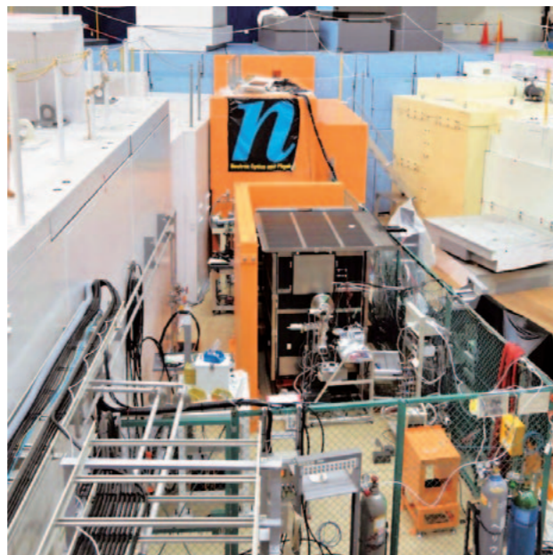
Figure 2: 大強度陽子加速器研究施設 (J-PARC) のスパレーション中性子源ビームポート番号BL05に配備された中性子光学基礎物理研究装置 (NOP: Neutron Optics and Physics). 中性子寿命測定のためのセットアップが見える。
