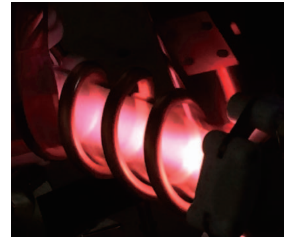
図3. らせん状に巻いた高周波アンテナにより生成されたプラズマの発光。
