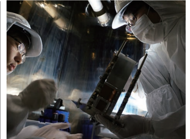
図2. 真空容器内でビーム計測器の改造を行っている様子。
