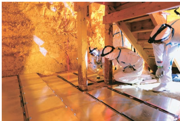
図2：屈折ピラミッドの内部に原子核乾板検出器を設置している様子（ScanPyramids）。
