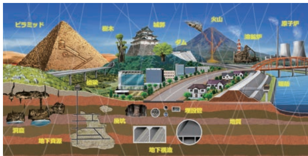
図1：宇宙線イメージングの対象。検出器を観測対象の周辺または下部に配置することで、地上構造物や地中を可視化する。
